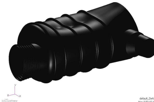
**Figura 7-6** Deformaciones en el depósito D-1200 (m), carga vertical (3.07 kN).
